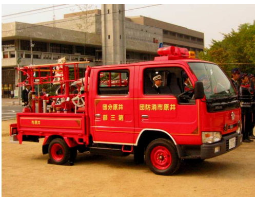
交付された小型動力ポンプ積載の消防車
